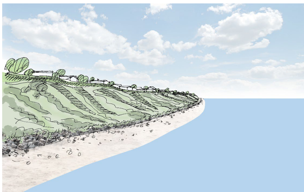
Figur 2.1: Overordnede kysttekniske principper for kystbeskyttelsesprojektet Nordkystens Fremtid, som omfatter strandfodring med sand, grus og ral (Kilde: Kystteknisk Skitseprojekt, 2016).
