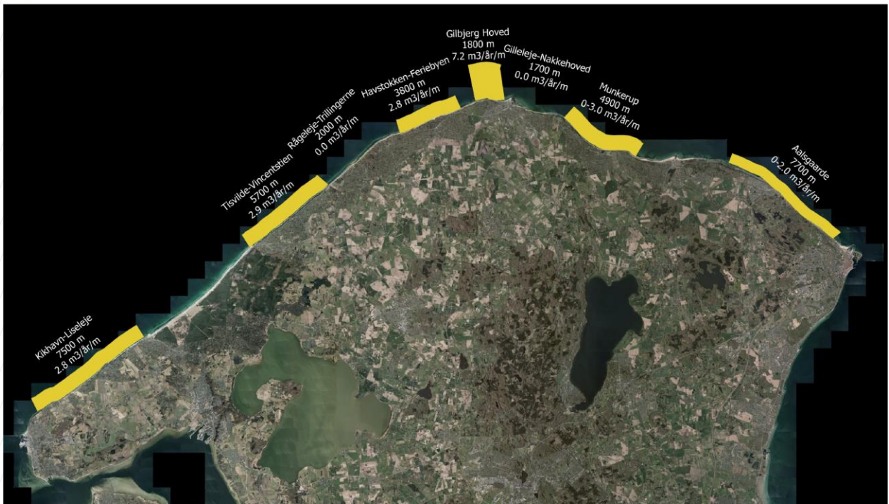
Figur 4.5 Modelleret kronisk erosion i hvert af fodringsområderne for eksisterende kyst. Erosion svarer til tab af sand.
