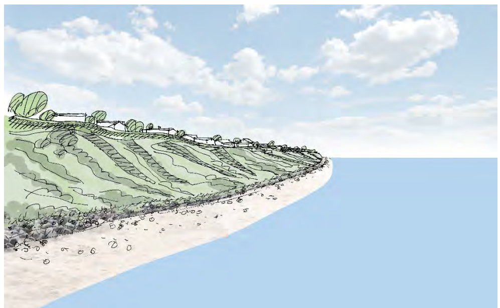
Figur 2-5 Overordnede kysttekniske principper for den foreslåede helhedsplan for kystbeskyttelsen på Nordkysten omfatter strandfodring med sand, grus og ral kombineret med skråningsbeskyttelser af sten
