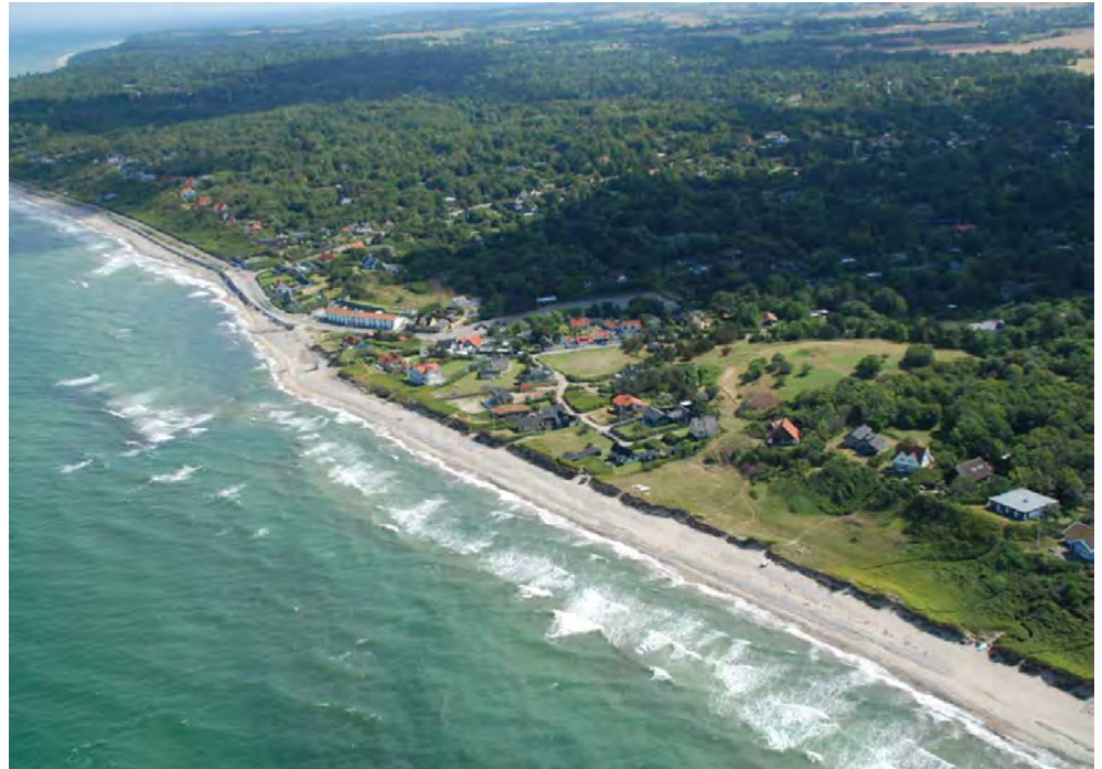
Figur 7-62 Kysten omkring den gamle bølgebryder i Rågeleje, som nu ligger som et stenrev under daglig vande. Luvside-aflejring mod sydvest og læside-erosion mod nord-øst
